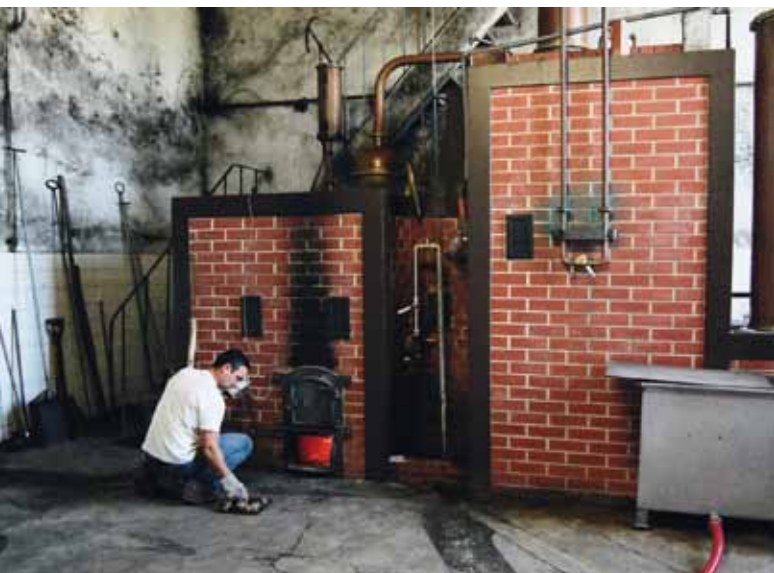
LES ALAMBICS DE QUINTA DO ROL sont chauffés grâce à un four à bois, maintenu à la température constante.
